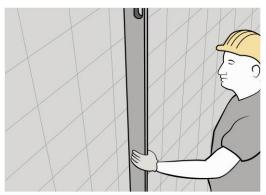
Проверьте плоскостность существующего основания / Check planarity of the existing substrate
